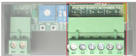
Figura 8: Conexão de Comando
