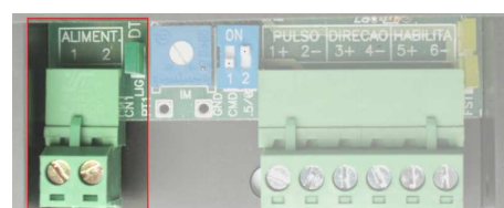
Figura 7: Conexão de Alimentação
