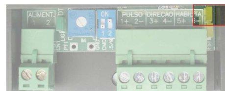
Figura 11: Indicador falha tensão
