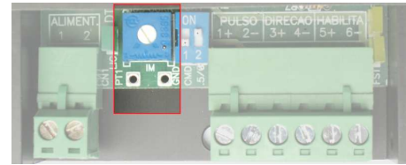
Figura 4: Potenciômetro de ajuste da corrente
