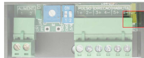
Figura 10: Indicador falha temperatura
