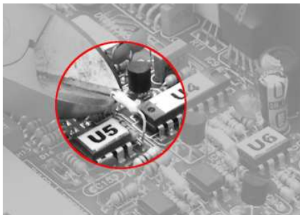
Figura 19: Remoção dos resistores de ajuste
